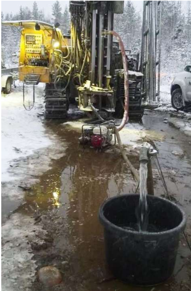
Kuva 27. Antoisuuspumppaus syvyydeltä 410 – 510 cm Sikahaarolla. Tilavuuksiltaan 65 dm 3 (kuvassa) ja 80 dm 3 saavien täyttymiseen kuluva aika kelloitettiin, jotta antoisuus saatiin laskettua.
