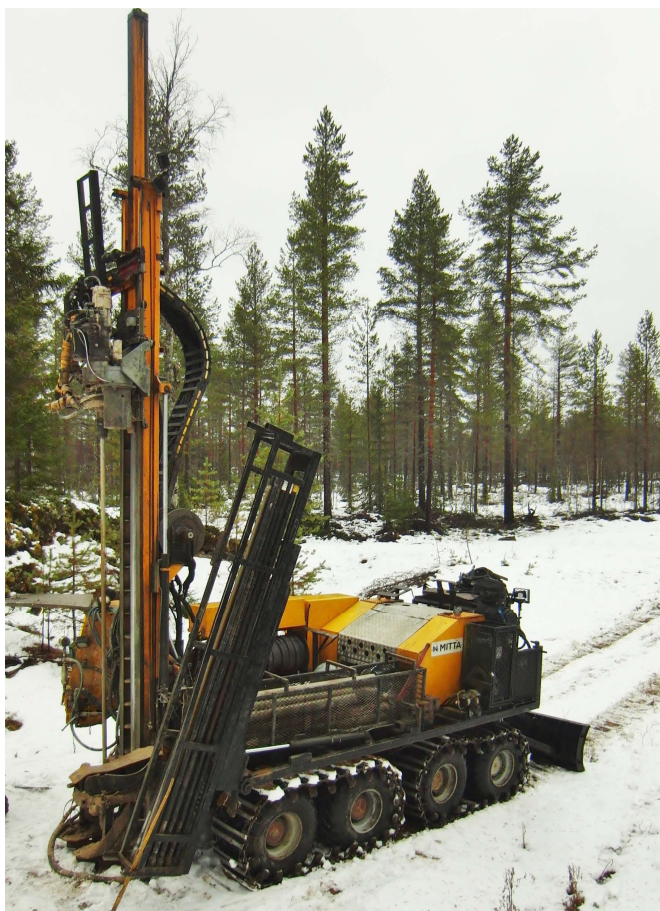
Kuva 9. Pohjavesialueiden maaperäkairauksiin käytetty GM-200 kairakone.
