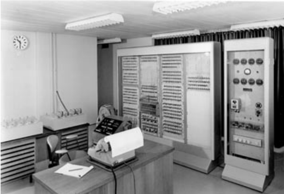
Kuva 23. ESKO valmiina toimintaan Helsingin yliopiston laskentakeskuksessa tai uudelta nimeltään matematiikan laskentatoimistossa 1960-luvun alussa. Etualalla näkyy tulostuslaite, sähkökirjoituskone. Sen takana koneen varsinainen ohjauspöytä. Ohjauspöydän takana erottuu muistirumpu, siitä vasemmalla reikänauhanlukkijat, joita oli kymmenen kappaletta. ESKOn kaappien takana oli verho, joka kätki huoltotilat käyttäjän silmistä. Helsingin yliopiston Tietotekniikkaosaston arkisto.
