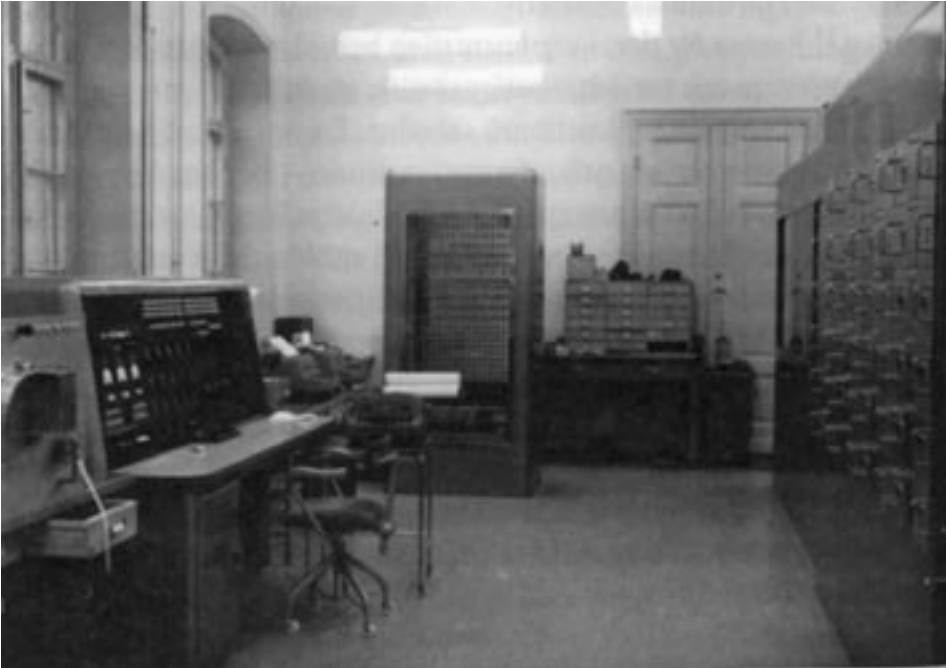
Kuva 5. Aikansa huippuna pidetty BESK-kone, joka vihittiin käyttöön Tukholmassa vuonna 1954. Suomalaiset nuoret tekniikan tekijät saivat Ruotsissa vieraillessaan mukaansa ehdotuksen jäljentää BESK Suomeen, mutta komitea arvioi sen tulevan liian kalliiksi. BESK:ssä seurattiin perusratkaisuja johtavasta yhdysvaltalaisesta, muistiin tallennettuun ohjelmaan perustuvasta EDVAC-konehankkeesta. Kuva: Carlsson 2004, 250.
