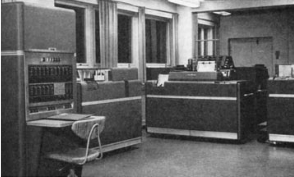
Kuva 20. Ensimmäinen Suomessa käyttöön otettu tietokone oli Postisäästöpankin Ensi-niminen IBM 650 oheislaitteineen (taustalla). Ensi asennettiin toimintaan lokakuussa 1958. IBM oli tuonut laitteiston maahan ennätysajassa, sillä se halusi voittaa Suomen ensimmäisen matematiikkakoneen tittelin Matematiikkakonekomitealta. Pankki myönsi pian komitealle luvan käyttää Ensiä laskentakeskusten tapaan öisin. Kuva: Rosenqvist 1959, 41.
