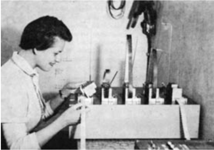
Kuva 13. Matematiikkakonekomitean apulaismatemaatikko, maisteri Kaarina Oksanen asentaa aliohjelman ESKOn syöttölaitteeseen, reikänauhanlukijaan. Kuvassa näkyy viisi yhteensä kymmenestä nauhanlukijasta. Matemaatikoiden rooli hankkeessa jäi odotettua vaatimattomammaksi, koska ESKO ei valmistunut arvioidusti vaan sen tekeminen venyi. Alun perin koneen piti olla käyttökuntoinen vuonna 1956. Kuva: Carlsson 1959, 32.
