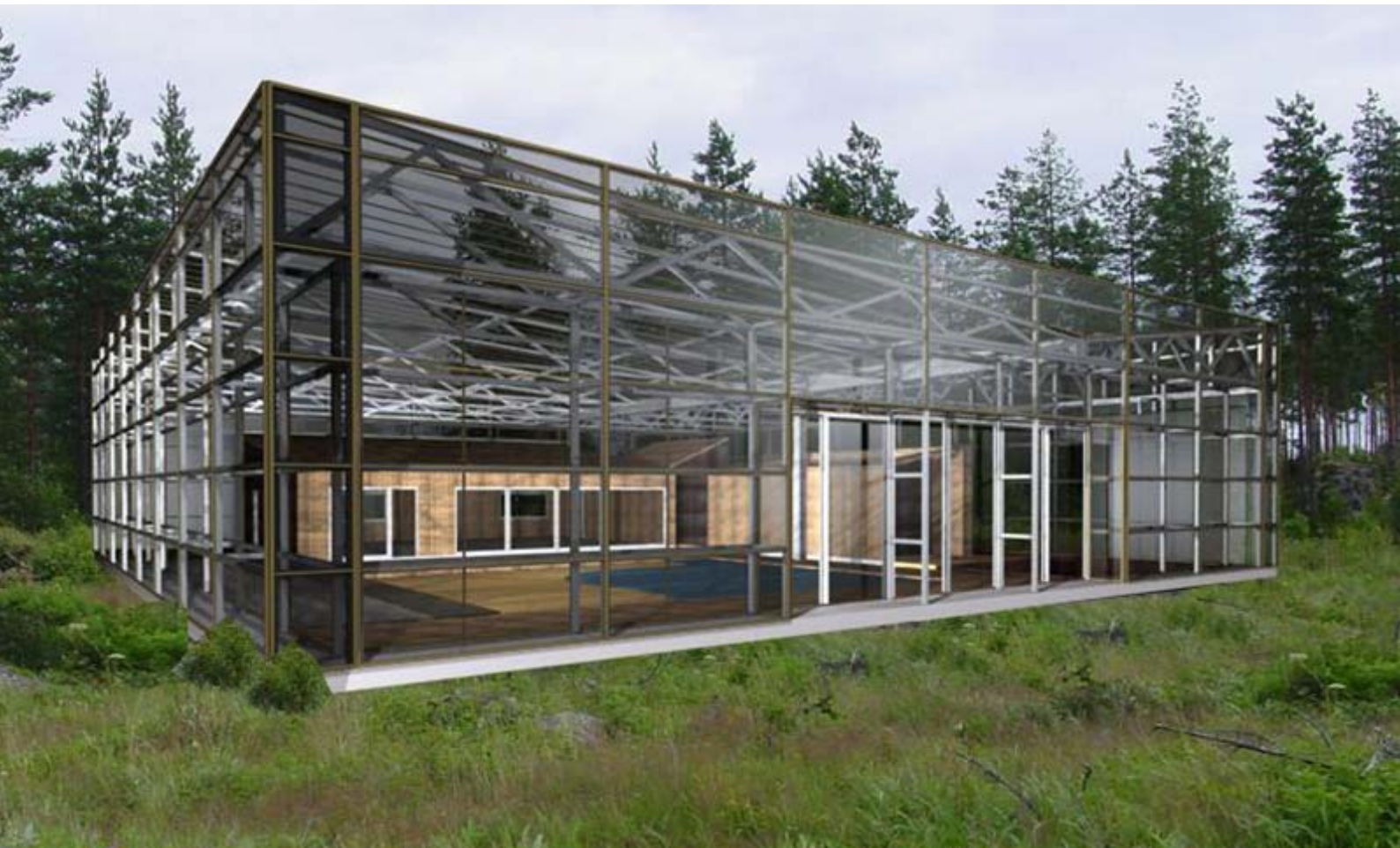
Kuva 30. Ekotalon asuinrakennukset tehdään merikonteista, ulkokehä kierrätetystä lasista. Kuva: Petra Savela/Arkkitehtiruutu Oy. 80
