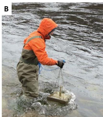
Kuva 32. A) Vedenpaineen perusteella vedenpinnan korkeuden vaihtelua mittaava Solinst Levellogger -sensori. Sensori kiinnitetään pohjastaan painoon ja asennetaan uoman tai altaan pohjaan siten, että sensori osoittaa mahdollisimman suoraan kohti pintaa. Kuva: Santtu Kaipanen. B) Levellogger-sensorin asennus veteen. Kuva: Leena Laamanen.
