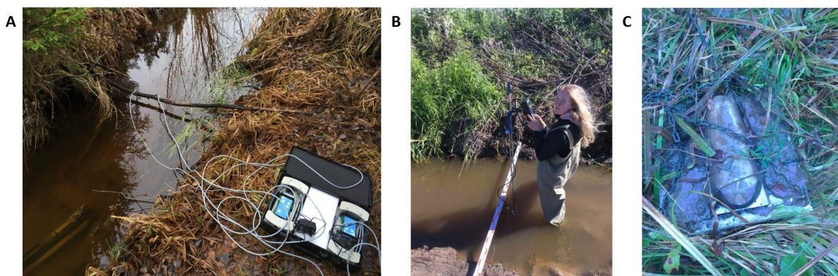
Kuva 33. Virtaamamittausten menetelmien käyttöä: A) suolapitoisuuden vaihteluun perustuva tracer-sensori kosteikon tulo-uomassa (vasemmassa alalaidassa nähtävillä jatkuvatoiminen ravinnemittari uoman pohjassa). B) Virtaaman mittausta Flowtracker-ADV:llä (ks. kuva 17 B). C) Jatkuvatoiminen ADCP-sensori mutaan peittyneenä. Kuvat A ja B: Santtu Kaipanen, kuva C: Jouni Salmela.
