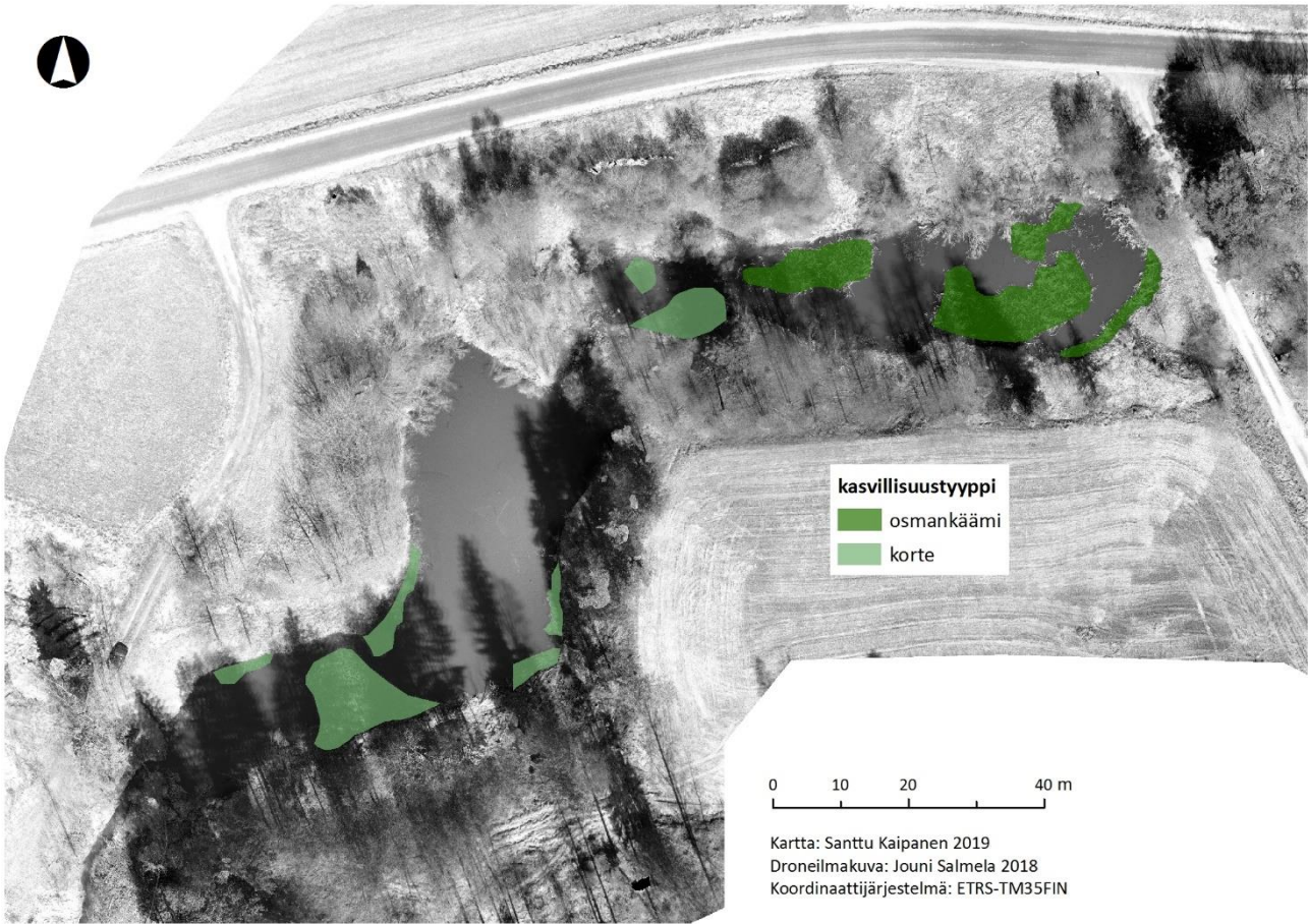
Kuva 59. Kasvillisuusalueet Imponojan altaissa. Kasvillisuusalueet ja luokittelu ovat samat, kuin virtaussimulaatioissa käytetyt. Laskeutusaltaassa kasvillisuutta on enemmän kuin Ekmanilla. Kosteikossa kasvillisuutta on melko runsaasti koko altaan alueella.
