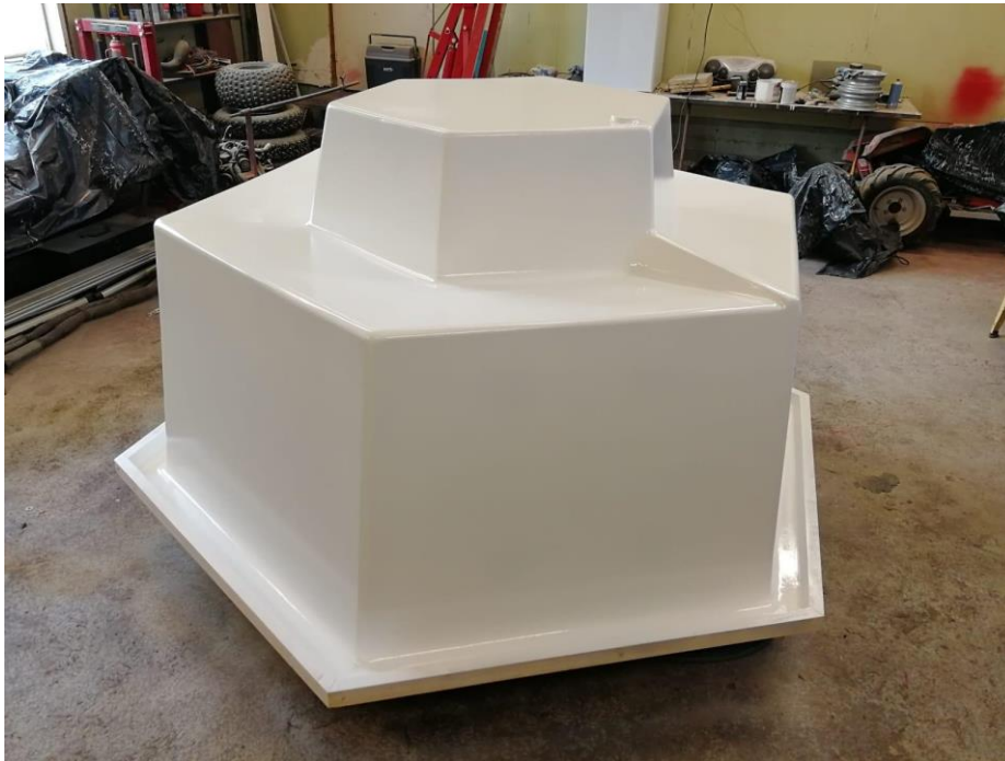
Kuva 7. Valmis muotti maalattuna.
