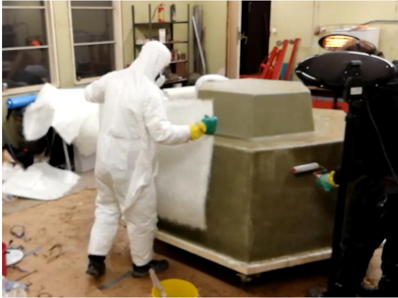
Kuva 11. Lasikuitukankaan asettelua ja kovatelaamista.
