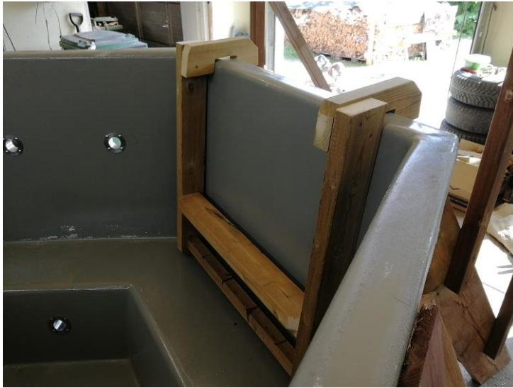
Kuva 18. Sisäpuolinen porrasaskelma ja vesiputkien läpiviennit.
