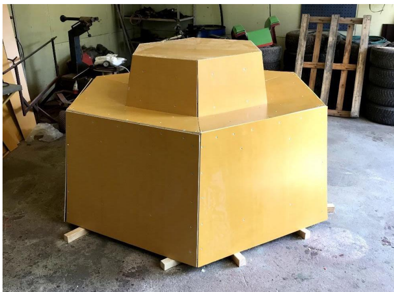
Kuva 4. Vaneroitu muotti puuvalmiina ilman kittauksia ja pyöristyksiä.
