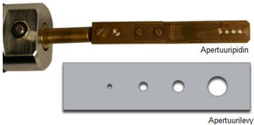
Kuva 18. Kuvassa apertuurin pidin ja itse apertuurilevy, jossa on erikokoisia reikiä. Reikien avulla muokataan elektronisäteen halkaisijaa. (muokattu lähteestä (16))
