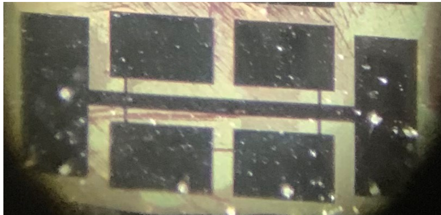
Kuva 9. Eräs työssä etsattu kalvo ja siihen tehty kuviointi.
