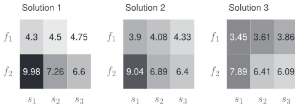
Kuva 14: Lämpömattokaavio kolmelle Pareto-optimaaliselle ratkaisulle. Jokaiselle ratkaisulle on tehty oma kaavionsa. Kuvan lähde: Shavazipour & al, 2021 [19].
