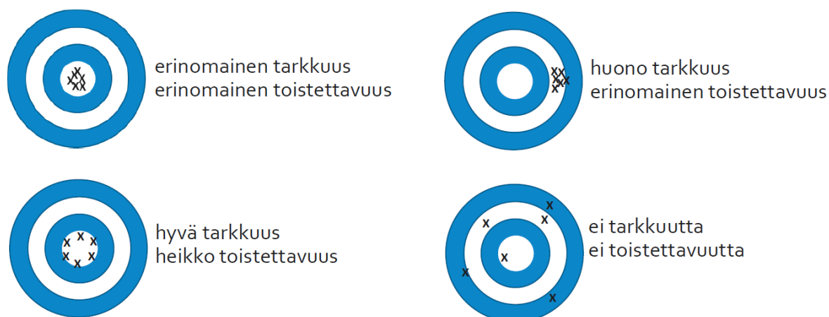
Kuva 1. Visuaalinen esitys analyysimenetelmän tarkkuudesta ja toistettavuudesta. Tarkkuudessa verrataan tulosta oikeaan todelliseen pitoisuuteen ja toistettavuudessa tulosten suhdetta toisiinsa.
