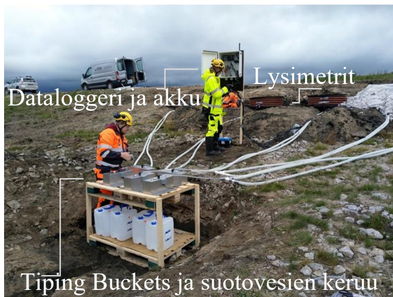
Kuva 6. Hituran koejärjestelyn laitteisto ilman sääasemaa (sääasema sijaitsee noin 100 m päässä kuvasta vasemmalla). Alkuperäinen kuva Teemu Karlsson/GTK.
