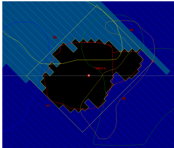
Kuva 5: Säteilyseläin rajaaminen kollimaattorin leuoilla ja moniliuskakollimaattoreilla. Keltainen suorakulmio esittää kollimaattorinleukoja ja siniset liuskat moniliuskakollimaattoreita. Liuskojen paksuus on 5 mm. Punainen ääriviiva esittää sädehoidon kohdealuetta. Muut värilliset viivat esittävät tervekkudoksia.
