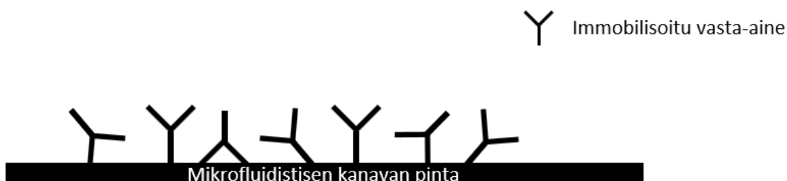
Kuva 3. Vasta-aineen immobilisointi adsorptiolla. Adsorptiolla immobilisoidut vasta-aineet kiinnittyvät mikrofluidistisen kanavan pintaan heikoilla vuorovaikutuksilla. Tämän vuoksi ne voivat sitoutua pintaan huonossa orientaatioissa, mikä voi johtaa aktiivisuuden menettämiseen.
