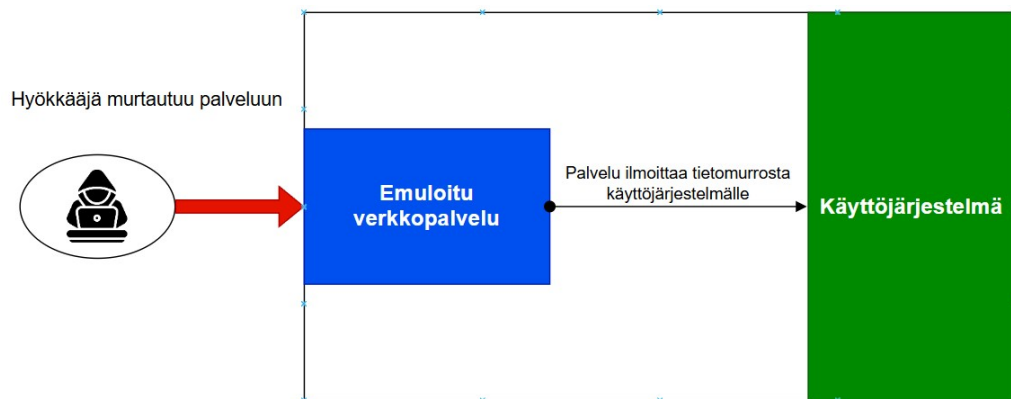
Kuva 3.1: Matalan vuorovaikutustason hunajapurkin toimintaperiaate
