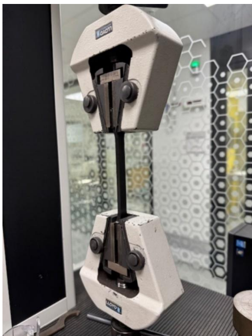
Kuva 5, Lloyd Instrumentsin LR 30 K kiinnikkeet ja kiinnitetty kappale, Tuukka Nurmela
