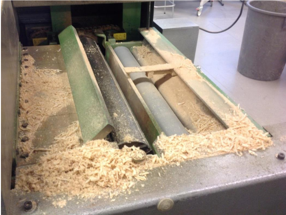
Kuva 7 Tasohöylän sisusta täynnä purua
