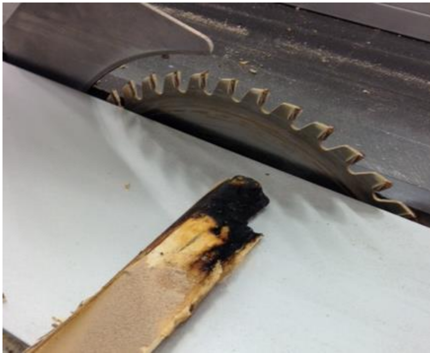
Kuva 6 Läheltä piti -tilanteen aiheuttanut kappale
