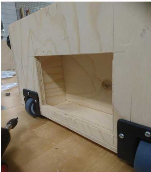
Kuva 30. Ylimääräistä lokeroa varten jyrssitty aukko sekä renkaat asennettuna.
