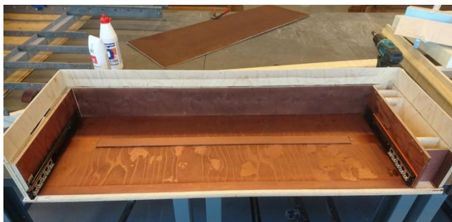
Kuva 58. Alaosan sisäpuolisten väliseinien liimaus. Taustalla välipohja maalattuna.
