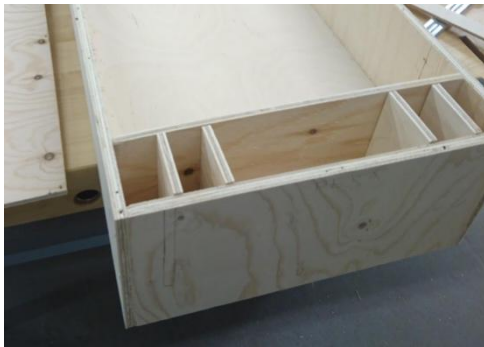
Kuva 28. Liukukiskoa varten rakennettu seinä sekä jäykistävät välilevyt.
