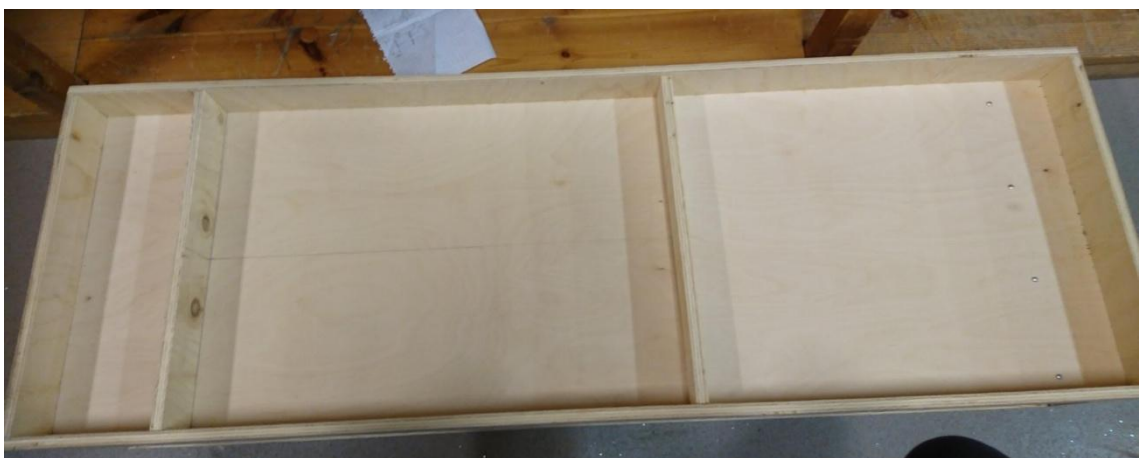
Kuva 32. Kiinteät väliseinät aietuotteen alaosan rungon ylemmässä osiossa.
