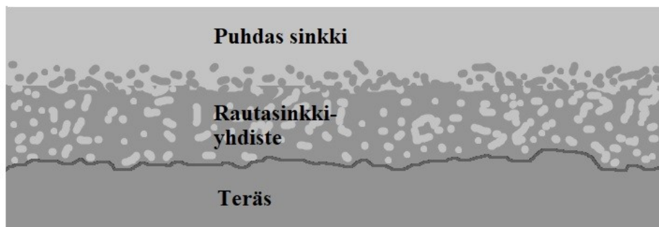
Kuva 18. Kuumasinkityn pinnan koostumus mukaillen Ansaharju ym. (1988, 177.)
