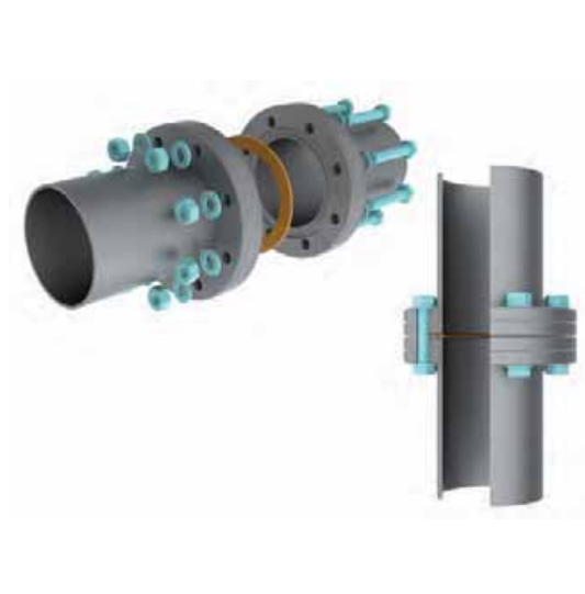
Kuva 15. CF-liitoksen periaate, jossa kuparitiiviste asetetaan laippojen väliin laipoissa olevaan uraan. Laipat kiristetään toisiinsa pulteilla. Kuva on lähteestä [24].
