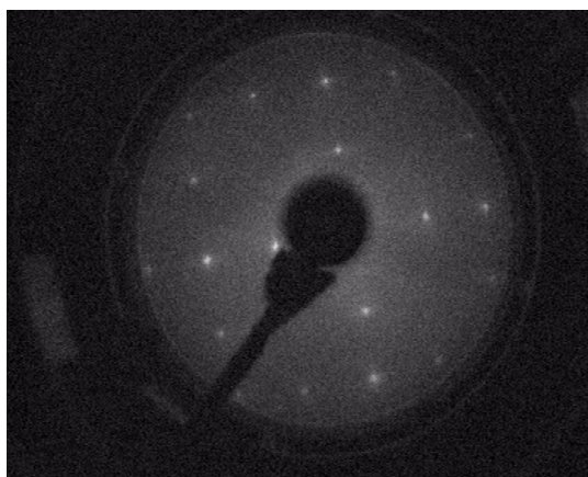
Kuva 24. Esimerkki LEED:ssä havaittavista diffraktiopisteistä. Kuvassa puhtaasti Si(100) pinnan diffraktiopisteet. LEED:n rakenteesta johtuen elektronivyöky peittää kuvan keskiosan.
