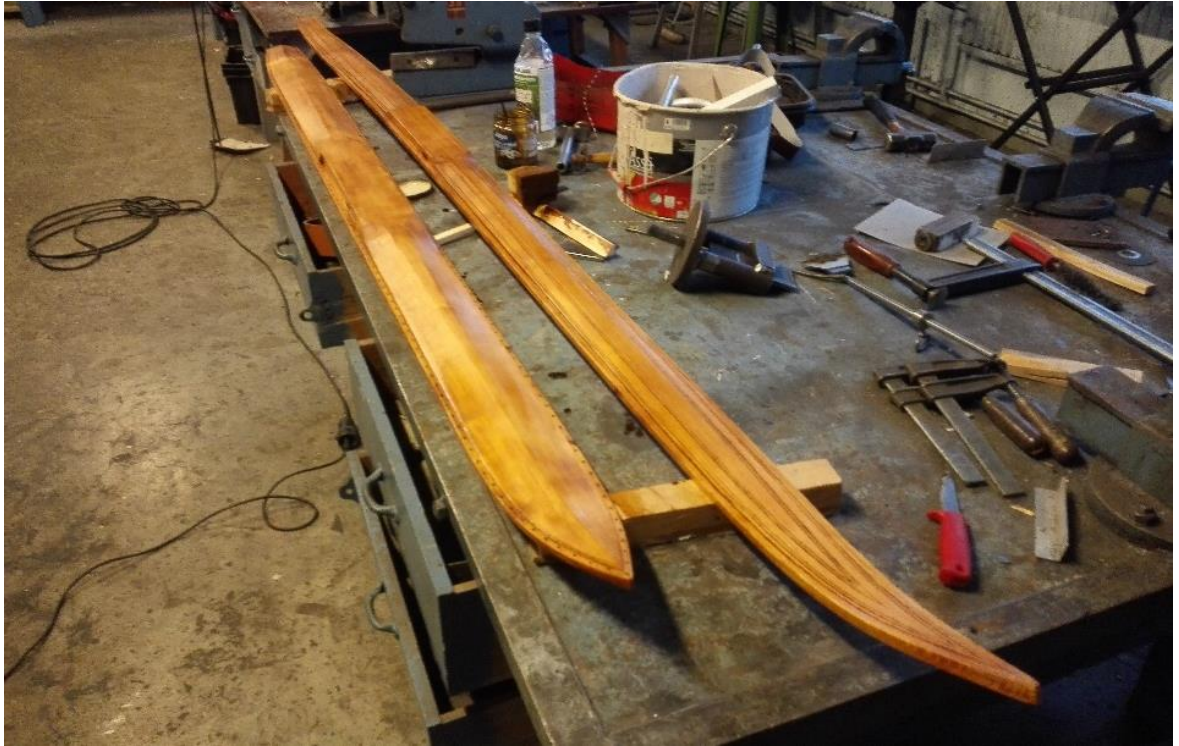
Kuva 71. Lyly ja kalhu ensimmäisen tervauksen jälkeen. (Kuva, Korteniemi 2019).
