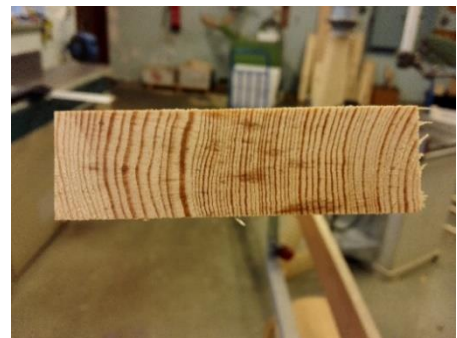
Kuva 46. Säteittäin sahattu lylysuksen aihio. (Kuva, Korteniemi 2019).
