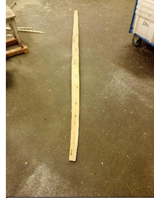
Kuva 45. Kieroutunut lylyn aihio. (Kuva, Korteniemi 2019).
