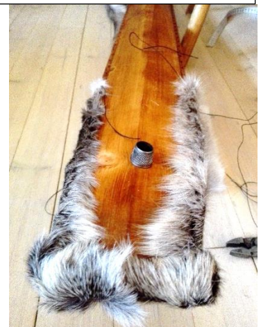
Kuvat 76-78. Vas. Suksenmittaiseksi jonoksi ompelemalla yhdistettyjä koipinahkapareja. Kesk. ja oik. Nahan ompelua suksen pohjaan kantin läpi neulan ja karhunlangan avulla. (Kuvat, Korteniemi 2019).
