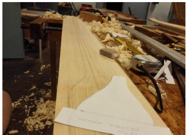
Kuva 62. Kalhun viisteiden höylääminen alkamassa. Kuvassa näkyy sabluuna, jonka avulla päläksen muoto on piirretty. (Kuva, Korteniemi 2019).
