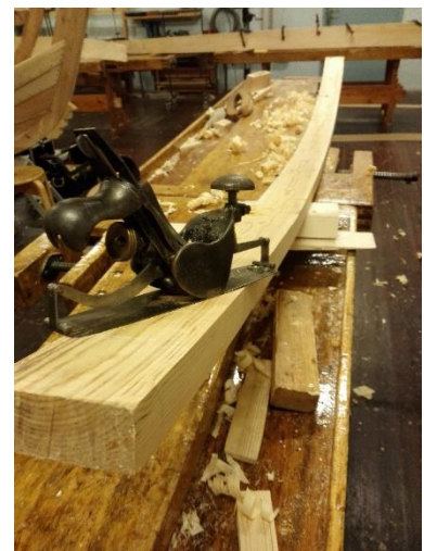
Kuva 44. Lylyn aihion höyläystä laivahöylällä. (Kuva, Korteniemi 2019).
