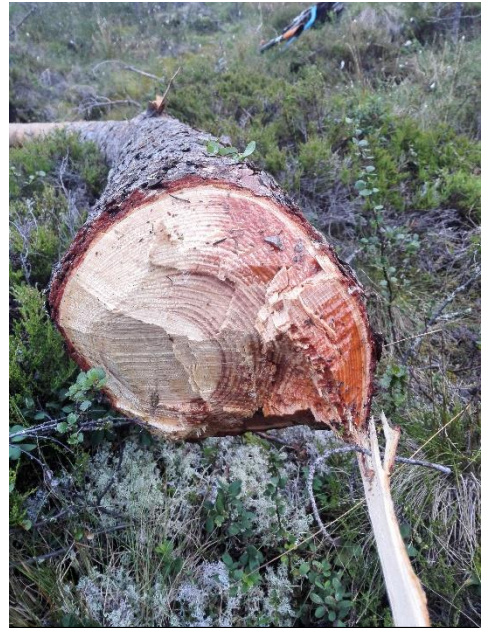
Kuva 43. Kaadetun lylymännyn poikkileikkaus. Kuvassa näkyy ovaali muoto ja pihkoittunut kuperan puolen lylypuu. (Kuva, Korteniemi 2019).
