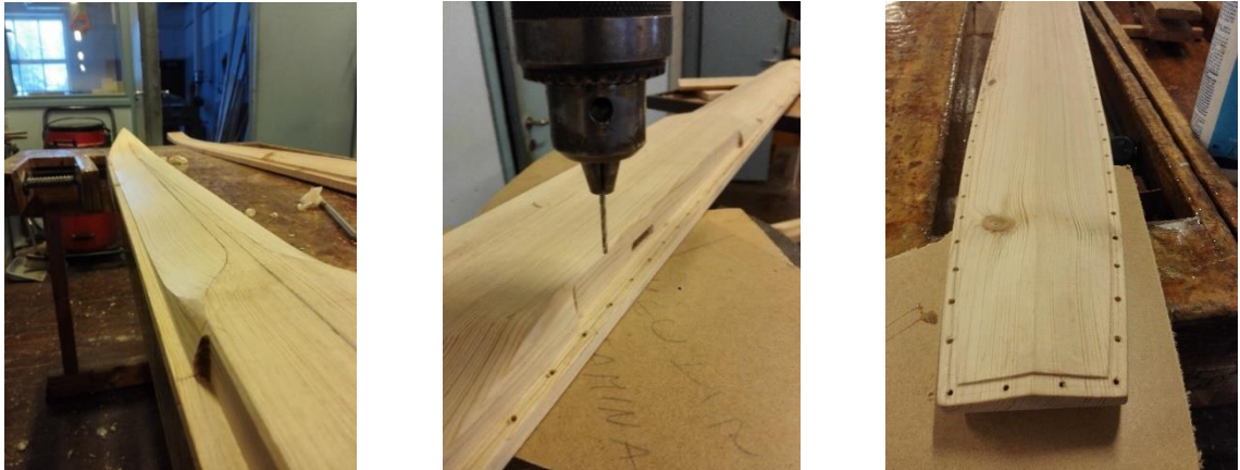
Kuvat 66-69. Vas. Kahun profilia. Kesk. Ompelureikien porausta. Oik. Kahun kanttia kiertävä reikäriivi. (Kuvat, Korteniemi 2019).
