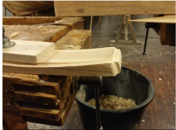
Kuva 51. Suksen kannan muotoilua. (Kuva, Korteniemi 2019).
