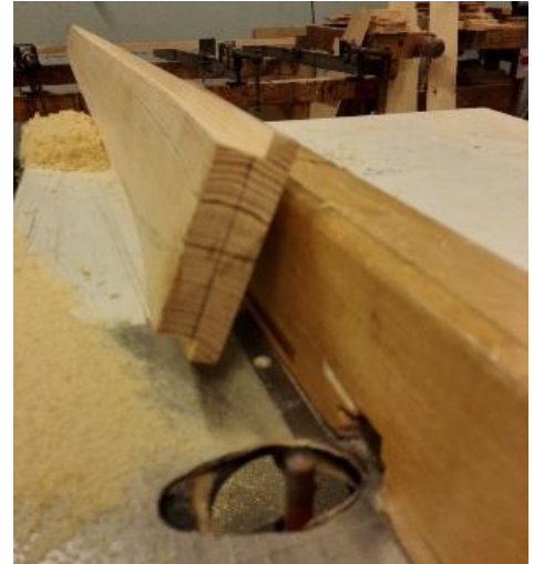
Kuva 49. Kantin ohennus alajyrsimellä. (Kuva, Korteniemi 2019).
