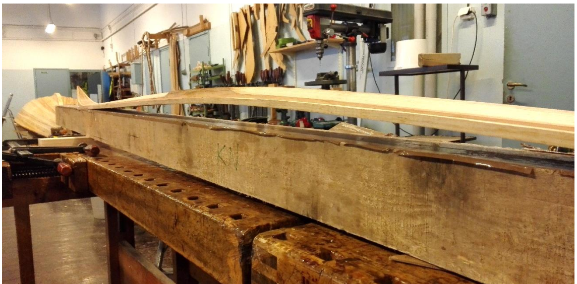
Kuva 54. Lylyn lopullinen jalkavuus suksen kuivuttua, noin 35mm. (Kuva, Korteniemi 2019).
