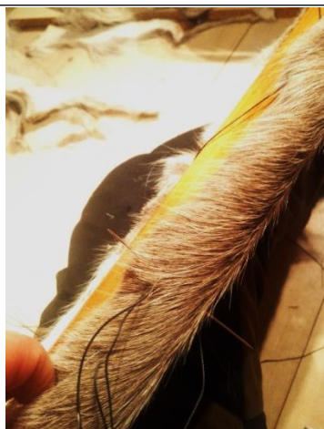
Kuvat 76-78. Vas. Suksenmittaiseksi jonoksi ompelemalla yhdistettyjä koipinahkapareja. Kesk. ja oik. Nahan ompelua suksen pohjaan kantin läpi neulan ja karhunlangan avulla. (Kuvat, Korteniemi 2019).
