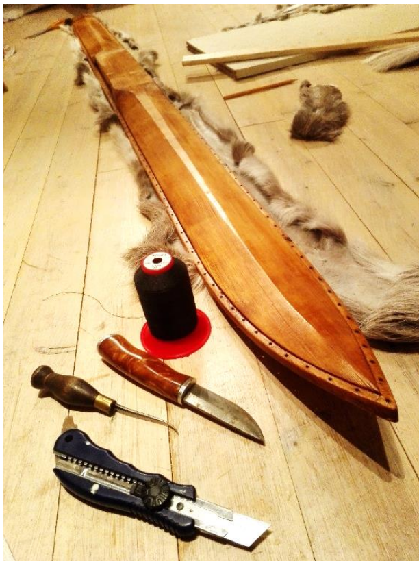
Kuvat 79 ja 80. vas. Kalhun kettämistä, työkaluina puukko mattoveitsi, naskali, neula ja lankaa. Oik. Valmis kalhun karvapohja. (Kuvat, Korteniemi 2019).
