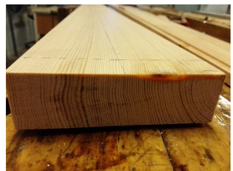
Kuva 61. Kalhun aihio tehtynä säteittäin sahatusta männystä. (Kuva, Korteniemi 2019).
