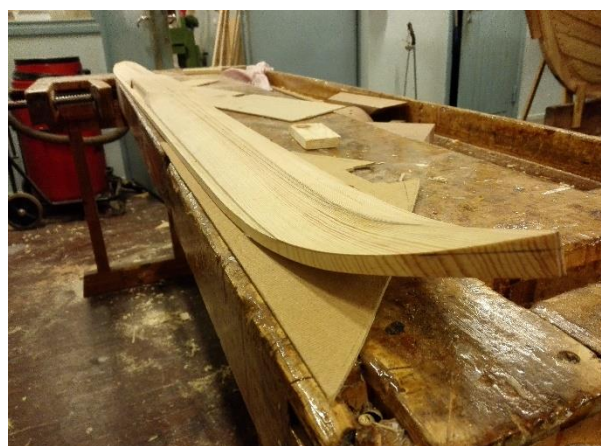
Kuva 65. Kahun kärjen muotoilua taivutuksen jälkeen. (Kuva, Korteniemi 2019).
