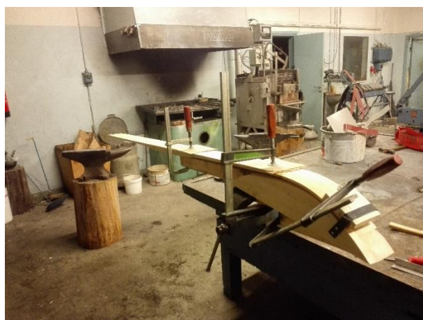
Kuva 64. Kahun kärjen taivutus muotissa. (Kuva, Korteniemi 2019).
