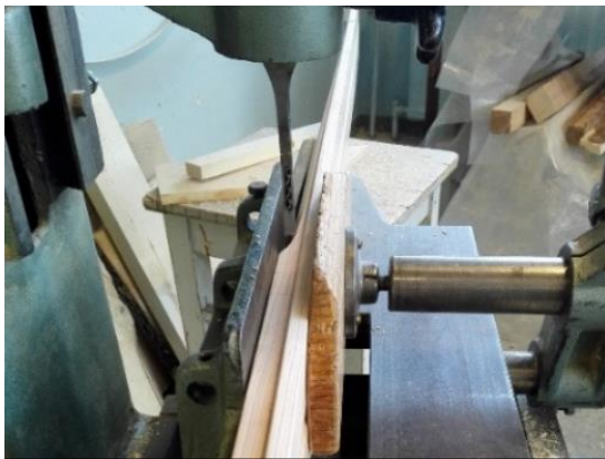
Kuvat 57-60. Ylh. vas. Lylyn viimeistelyä. Ylh.oik. Lylyn loppuhionta. Alh.vas. Poratalttakoneella mäystimen reiän tekoa. Alh.oik. Valmiit mäystimen reiät. (Kuvat, Korteniemi 2019).
