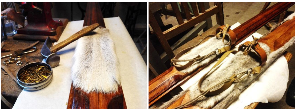
Kuvat 81 ja 82. Vas. Tallan kiinnitystä messinkinauloilla lyllykseen. Oik. Nahkasta valmistetut siteet; mäystimet ja kannantakaiset. (Kuvat, Korteniemi 2019).
