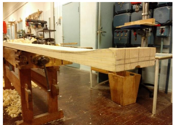
Kuva 48. Suksen ohennus haluttuun muotoon käsihöyläiden avulla. (Kuva, Korteniemi 2019).
