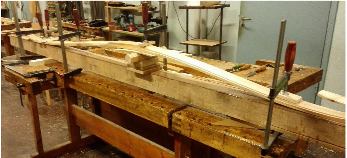
Kuva 53. Jalkavuuden tekeminen lylysukseseen taivuttamalla. Ennen taivutusta suksi on ollut höyryssä. (Kuva, Korteniemi 2019)
