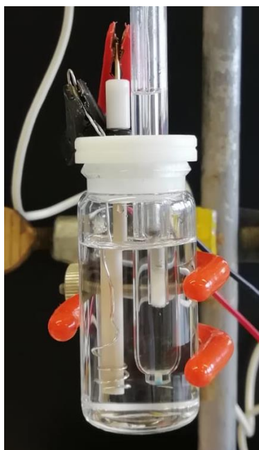
Kuva 4 Sähkökemiallinen kenno, jossa elektrodit upotettuna elektrolyyttiliuokseen.
