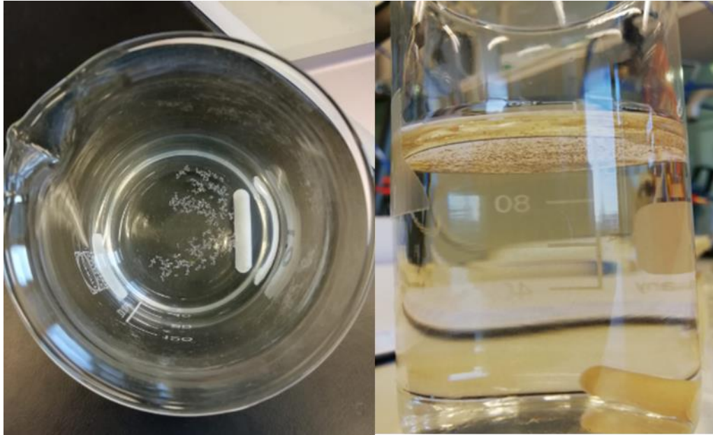
Kuva 10 Vasemmalla liuotuksessa muodostunut valkoinen sakka. Oikealla muodostunut tumma, hilemäinen sakka nestepinnan alapuolella.
