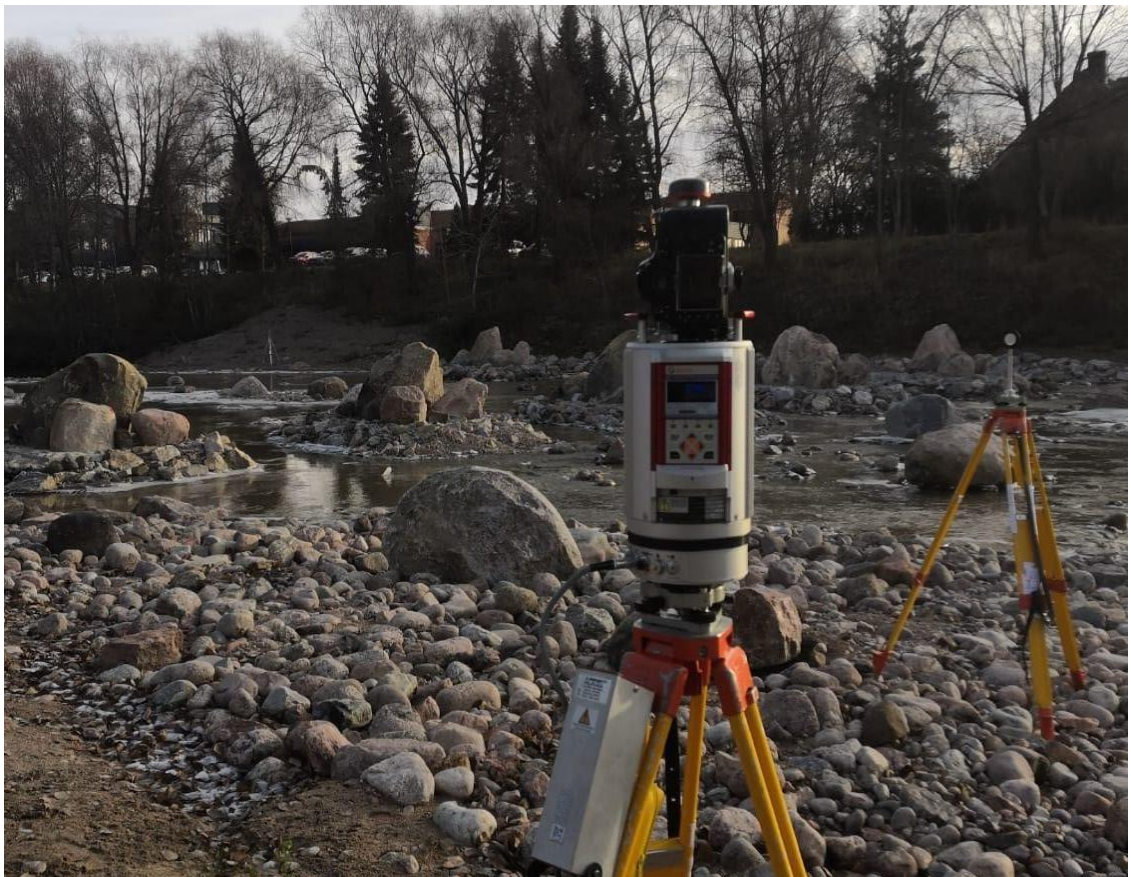
Kuva 12. Esimerkki maalaserkeilaimen käytöstä ja laserkeilausmittauksen toteuttamisesta jokiympäristössä. Kuvassa laserkeilan ja tähy, taustalla Moisionkosken jäänpidätysrakenteet. Kuva: Linnea Blåfield 2019.
