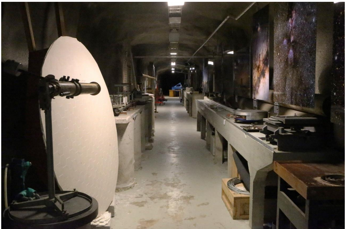
Kuva 14. Tuorlan tunnelin pääkäytävä. Vasemmalla on kaukoputki, kaakeleista tehty hiontalevy 1980-luvulta ja Väisälä-komparaattori. Oikealla on poljettava hiomapöytä Phoenixin ajoilta ja betoninen mittaustaso. Kuva: Jaana Saarikoski
