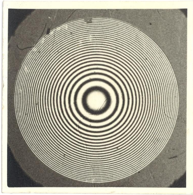
Kuva 13. Interferenssikomparaattorilla otettu kuva valon interferenssi-ilmiöstä. Alkuperäinen kuvaaja tuntematon. Kuva: Jaana Saarikoski
