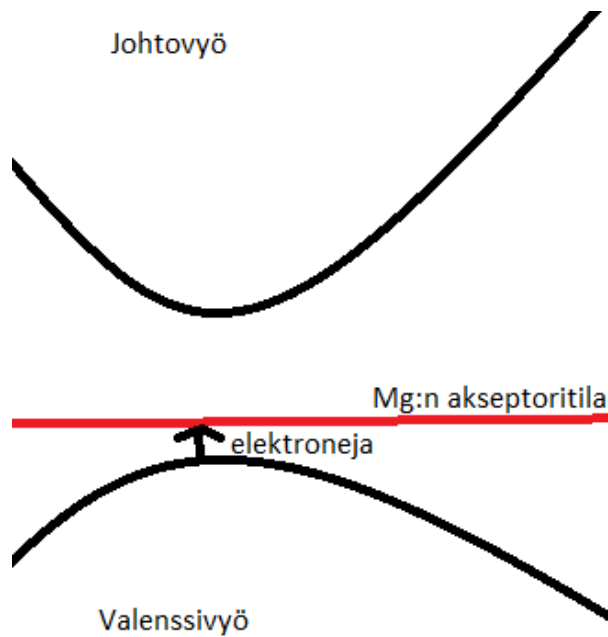
Kuva 2. Periaatekuva Mg:n pirstämisen vaikutuksista. Kuvassa Mg synnyttää akseptoritilan, johon elektronit voi siirtyä valenssivyöltä. Johtovyö ja valenssivyö on piirretty aaltovektorin ( k ) funktiona ja energia-aukko on näiden vöiden pienin välimatka energia-asteikolla.
