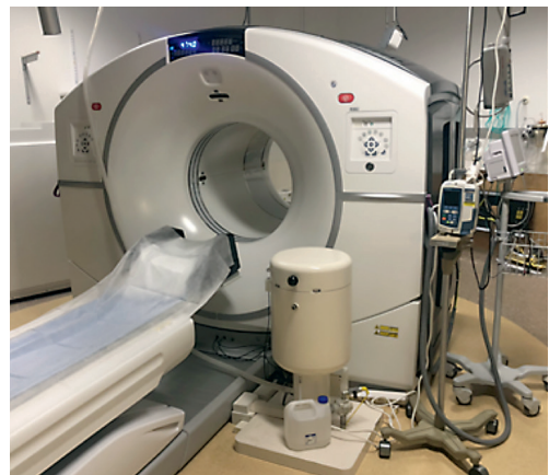
KUVA. Uuden sukupolven digitaalinen PET-TT, jossa TT-kuvauslaite edessä ja PET takana. GE Discovery MI, Turun yliopistollinen keskussairaala, PET-keskus.
