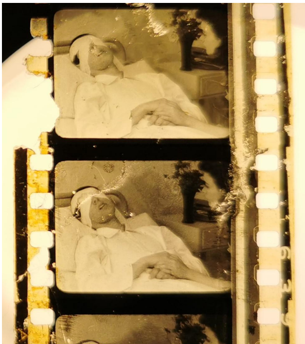
Kuva 2. Pahoin vaurioituneita nitraattifilmiruutuja Aarne Kivimäen ohjauksen Miehen vankina (1943) esityskopiosta, joka tehtiin Agfan 35-milliselle materiaalille. Kuvaa kohti on neljä perforaatiota, ja optinen ääniraita näkyy kuvassa oikealla. Kuva: Hannu Salmen kokoelmat.
