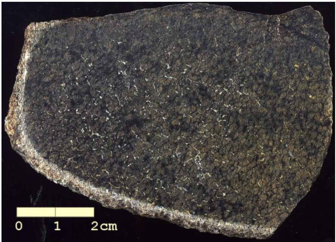
Kuva 64. Sahattu ja lakattu käsinäyte paljastumalta JKI-101H-96, Suomussalmi -ryhmä, keskirakeinen oliviiniortokumulaatti. Käsinäytteestä on ohuthie 225 ( Liite 5 ). Oliivinipseudomorfit ovat tervettä primääriserpentiiniä ja magnetiittia, "mesh" -rakenne, ja interkumulus osin karbonaattiutunutta serpentiinitöhkää.
