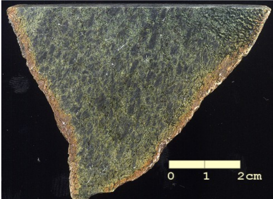
Kuva 70. Sahattu ja lakattu käsinäyte paljastumalta JKI-126C-96, Suomussalmi-ryhmä, oliviinikumulaatti. Käsinäytteestä on ohuthie 235 ( Liite 5 ). Oliiviinad-mesokumulaatti vaihtuu harrisiitiksi, (kuvan oikea ylänurkka). Oliiviinipseudomorfit ovat karbonaattimagneetiittiseosta ja interkumulus serpentiiniä.
