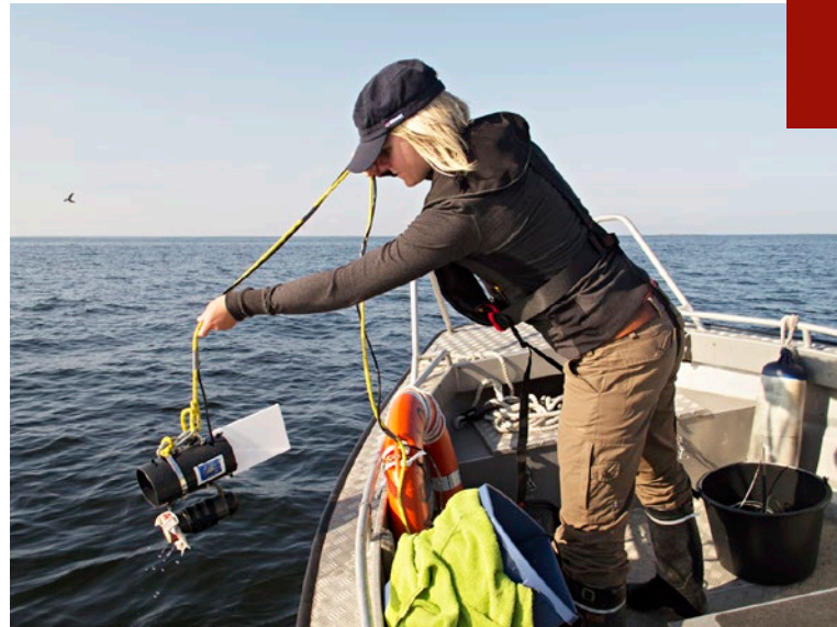
Kuva 5.2. Velmu-kartoituksissa havaintopisteen kuvaaminen vedenalaisella videokameralla (niin sanottu drop-videointi) on ollut yksi yleisimmistä käytetyistä kartoitusmenetelmistä. Kuva: Majju Lanki, Metsähallitus
