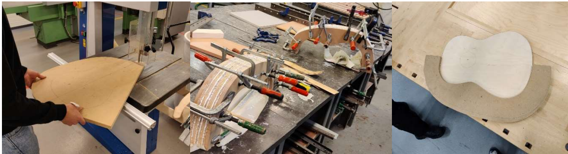
Kuva 6. Vas. Ensimmäisten muottikappaleiden leikkaaminen vannesahalla. Kesk. Kappaleiden liimaus. Liimauksessa puristimien kiristyskahvat vuorotellen toisella puolen pakkaa. Oik. Muotin muodon tarkistaminen laserleikatun kansimallineen avulla. (Kuvat, Mustajärvi & Wendelius 2021)
