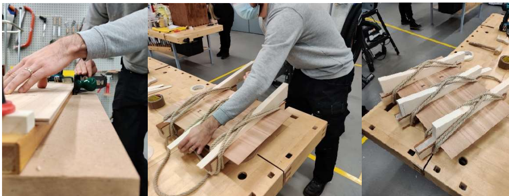
Kuva 9. Vas. Pohjaviilujen liimapintojen samanaikainen höyläys, jolla varmistetaan liimapintojen yhdensuuntaisuus. Kesk. ja oik. Pohjan puolikkaiden liimaaminen perinteisellä köysi-kiilapuristimella. (Kuvat, Mustajärvi 2022)
