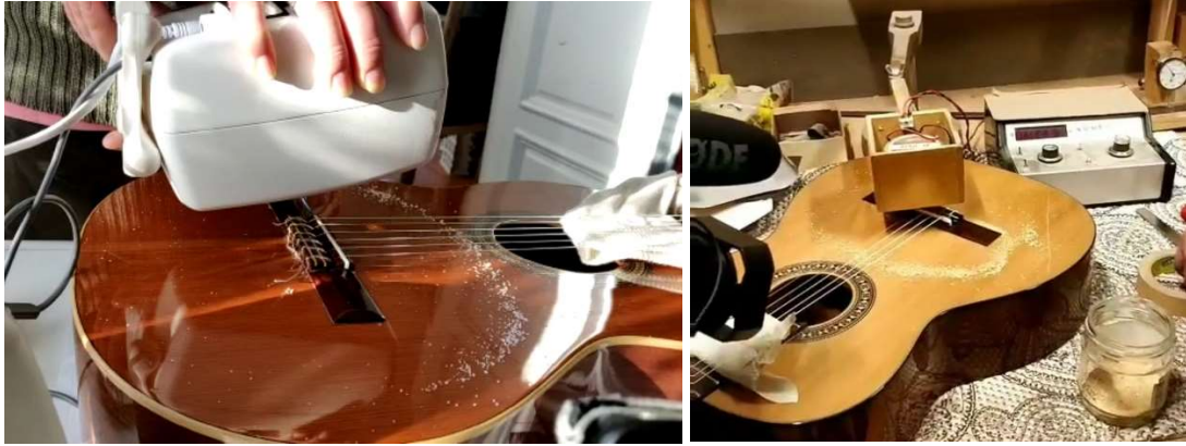
Kuva 1. Vas. Kitaran kantta altistetaan kaiuttimen tuottamalle siniaallolle. Mitattavan vertailukitaran ensimmäinen ominaisresonanssitaajuus on 204 Hz. Oik. Liikasen mittauslaitteisto, vertailukitaran ensimmäinen ominaisresonanssitaajuus on 203 Hz. Suolarakeiden muodostama kaari näyttää värähtelyn solmukohdan N , kaaren keskellä, tallan kohdalla on kupukohta A . (Kuvat, Wendelius & Mustajärvi 2020).
