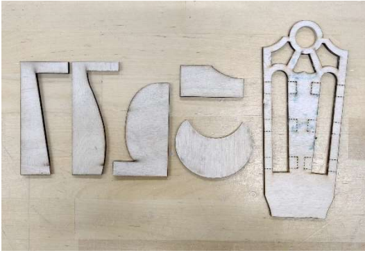
Kuva 7. Laserleikattuja sapluunoita, joista viisi vasemmanpuoleista sapluunaa on kaulan muotoilun avuksi ja oikealla laserleikattu lavan malline on lavan muotoilun avuksi.
