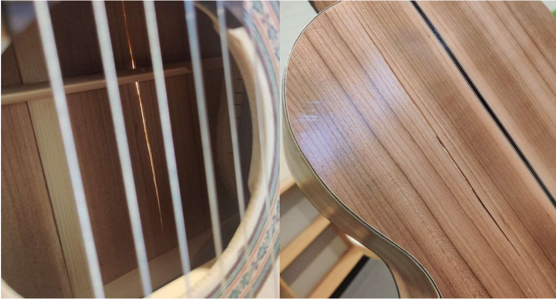
Kuva 20. Vas. pohjan halkeama kaikukopan aukolta kuvattuna, Oik. Halkeama pohjasta pain kuvattuna. (Kuvat, Mustajärvi 2022.)
