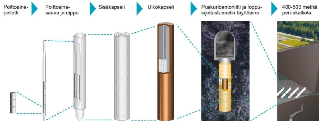
Kuva 9. Onkalossa käytettävän loppusijoituskapselin rakenne. Kapselin ulkokuori on valmistettu kuparista, ja sisäosa pallografiittivaluraudasta. [17]
