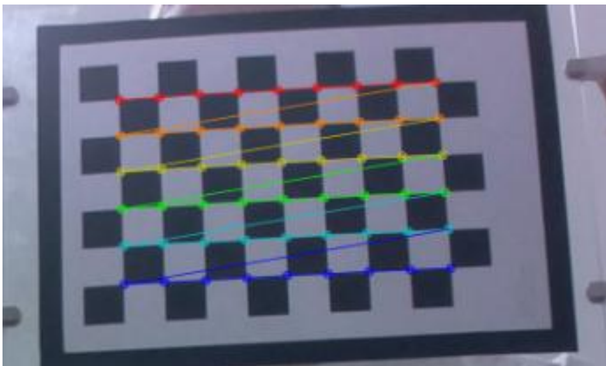
Kuva 2: Kalibroitiruudukko, jossa kulmat määritetty ja visualisoitu.
