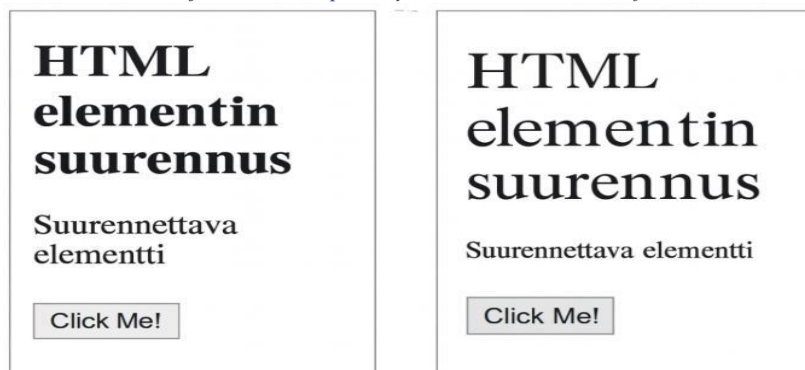
Kuva 1. Näyte HTML-koodista, jossa JavaScriptiä käytetään DOM-elementin fonttikoon muuttamiseen.
