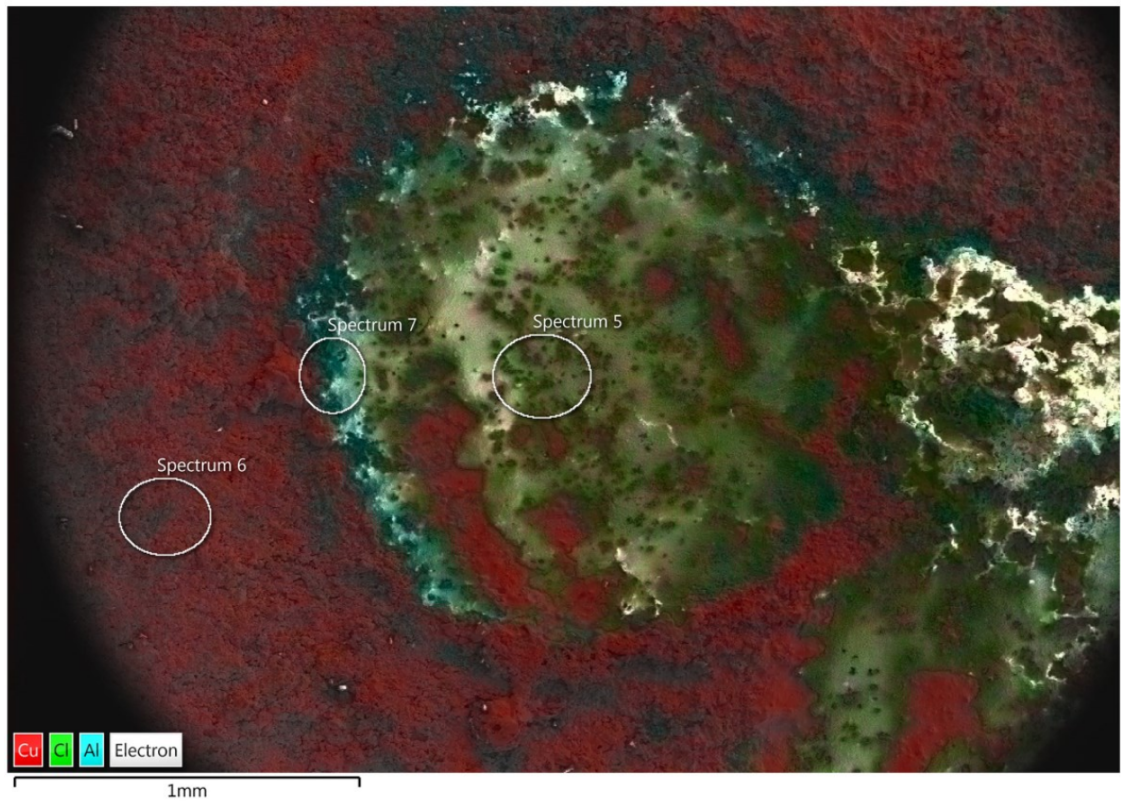
Kuva 2. SEM-EDS mittaukset kuparirahasta, joka on peräisin 1700-luvun alusta [3]. Eri alkuaineet on merkitty kuvaan eri väreillä.
