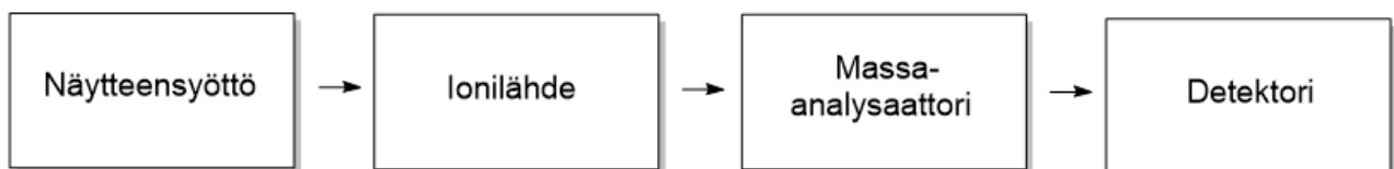
Kaavio 1. Massaspektrometrin menetelmän yleinen kaaviokuva.
