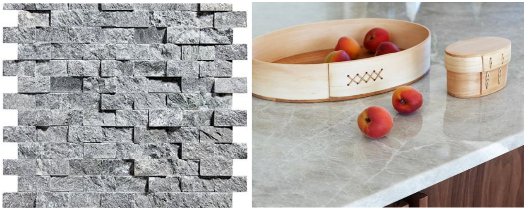
Kuva 15: Lohkottu pinta (vas.) ja kiillotettu pinta (oik.) (Muokattu Tulikivi Oy pohjalta).
