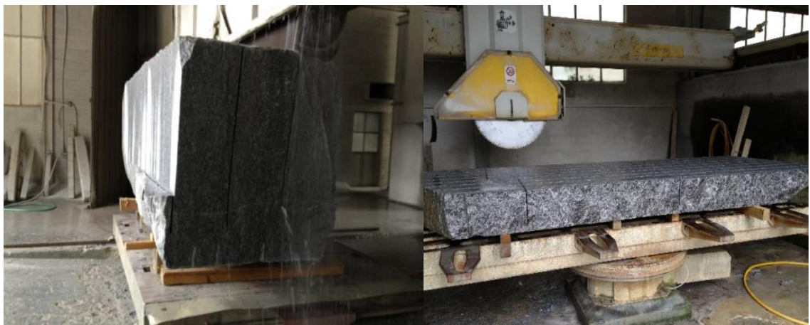
Kuva 14: Lohkareen sahaaminen levyksi (vas.) ja levyn sahaaminen katukivetykseksi. (Ioannidou 2016).
