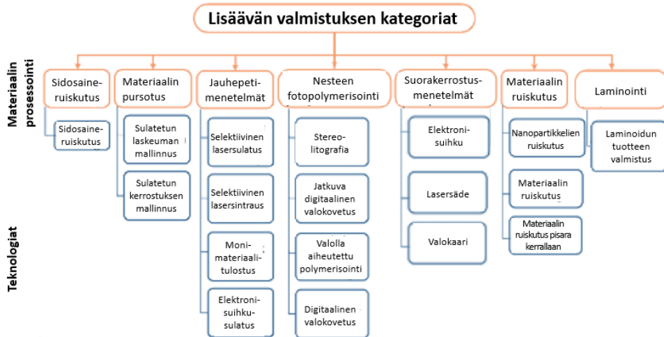
Kuva 6. Teollisessa 3D-tulostuksessa hyödynnettävät pääteknikat sekä niiden variaatioita.
