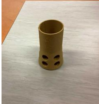
Kuva 30. Puufilamentista valmistettu kaiutinkotelo.
