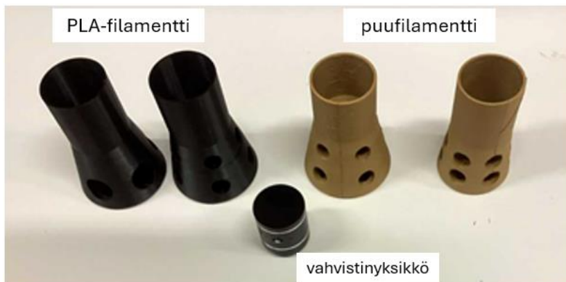
Kuva 31. Kaksi versiota mustasta PLA-filamentista valmistettua kaiutinkoteloita, kaksi versiota puufilamentista valmistettua kaiutinkoteloita sekä kaiuttimen vahvistinyksikkö.
