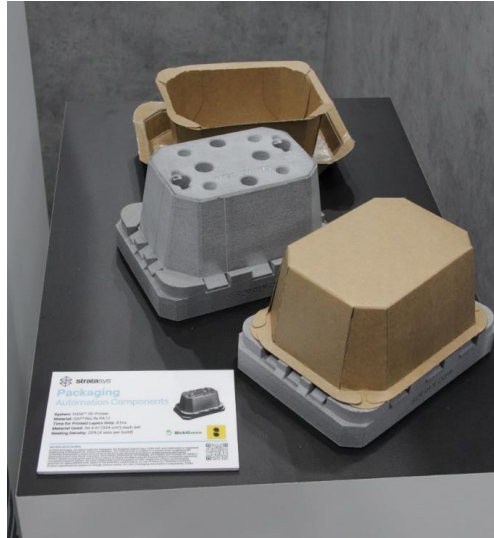
Kuva 19. PA12-muovista (Nylon) 3D-tulostettu pahvipakkauksen muotti. (Kuva: Erik Haapa)
