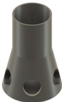
Kuva 24. Kaiutinkotelon 3D-malli (Jokinen, 2024).
