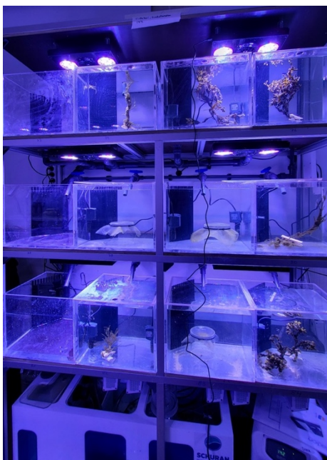
Kuva 3. Läpivirtaus-akvaarioräkki. Kokeessa räkettä oli kolme, joista kaikissa oli yhdeksän akvaariota käytössä. Kuva: Katja Mäkinen.
