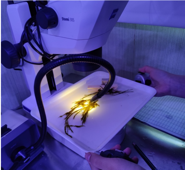
Kuva 5. Mätimunia tarkasteltiin stereomikroskoopin läpi käyttäen valonlähteenä erillistä kylmävaloa. Mätimunia laskettiin kahden käsilaskurin avuin. Kuva: Laura Lammi.
