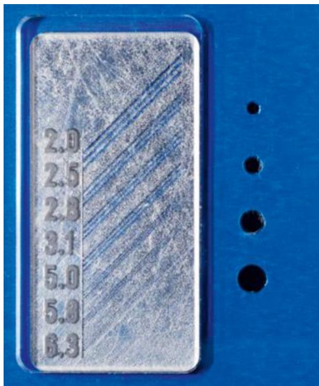
Kuva 7. Kuvanlaadun testauslevy. (Kirjasta Whites ja Drage, Essentials of Dental Radiography and Radiology, 2021 7 )
