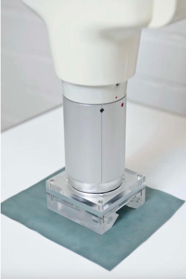
Kuva 2. Intraoraalilaitteen laadunvarmistuksessa käytetty fantom. (Kuva STUK, Hammasröntgentoiminnanlaadunvalvonta ja kuvaushuoneen säteily suojaus, 2011)
