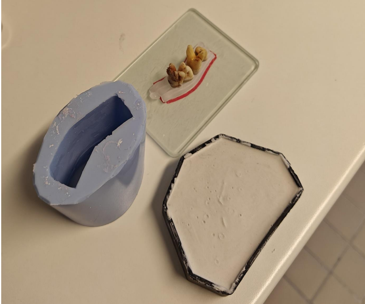
Kuva 5. Fantomin valmistuksen vaiheet: jalusta valettiin valumuottiin, jonka päälle asemoitiin ja valettiin silikonimuotti. Hampaat asemoitiin lasilevyllä ortodonttista vahaa hyväksikäyttäen. Hampaat upotettiin silikonimuotin vielä pehmeään kipsiin ja annettiin kovettua.
