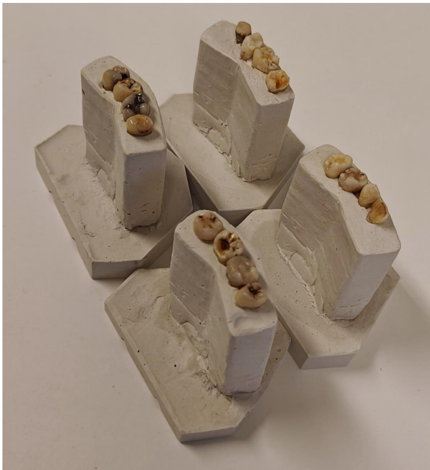
Kuva 6. Työssä valmistetut hammasfantomit.
