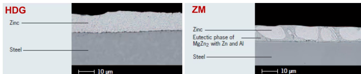
Kuva 11. Kuumagalvanointi ja sinkki-magnesium (ZM) pinnoitteet, mikroskooppinäkömää (Hilti, 2023).
