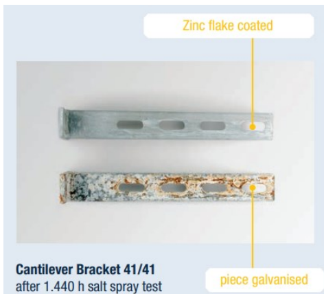
Kuva 10. Kuumagalvanoitu ja sinkkihiutalepinnoitettu kappale suolasumutestin jälkeen (Sikla, 2022, s. 2).
