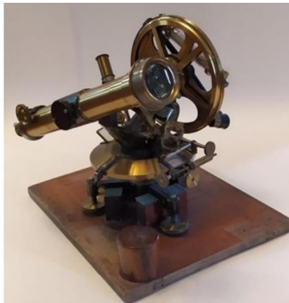
Kuva 2: Teodoliitti. Työvälinettä on käytetty kulmien mittaamiseen geodesiassa ja sen on valmistanut Max Hildebrand vuonna 1881. Sijaitsee fysiikan museossa Tomskissa. Kuva:
