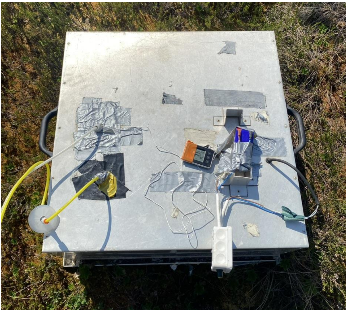
Kuva 2. Metaanivuomittauksissa käytetty alumiinikammio asetettuna kaulukselle. Vasemmalla kaasuanalysointilaitteeseen johtavat sisään- ja ulostuloletkut, keskellä kammion sisälle johtava lämpömittari ja oikealla kammion sisällä olevan tuulettimen akku ja nopeussäädin. Kuva: Veera Bilaletdin.
