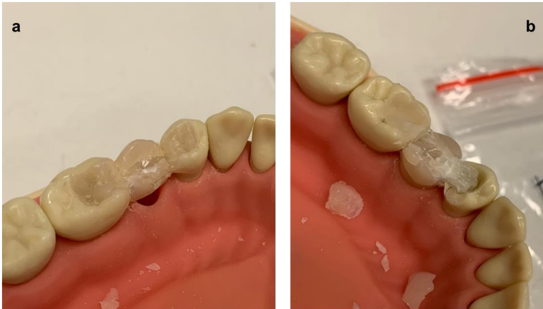
Kuva 32. Kaviteetti kiinnitteinen 3-yksikön lasikuitusilta kuormitustestin jälkeen. a. injektio tekniikalla valmistettu lasikuitusilta ja b. perinteisellä tekniikalla valmistettu lasikuitusilta. Murtumatyypit: a. välihampaan yhdistelmämuovin lohkeaminen ja b. välihampaan ja tukihampaan yhdistelmämuovin lohkeaminen ja delaminaatio, sekä tukihampaan kuspין lohkeaminen.
