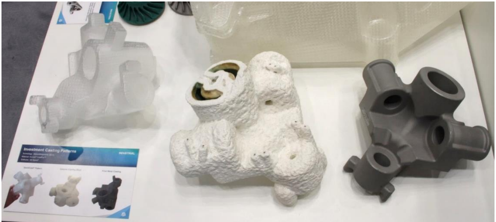
Kuva 20. Vasemmalta oikealle: muovista tulostettu hiekkavalumuotin malli, itse hiekkavalumuotti, ja muotilla valettu metallikappale. (Kuva: Erik Haapa)
