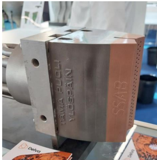
Kuva 18. 3D-tulostettu terästehtaan polttimen prototyyppi. (Kuva: Erik Haapa)
