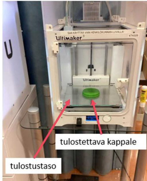
Kuva 22. UltiMaker 3 -tulostin sekä ensimmäinen PLA-filamentista tulostettu yksinkertainen kappale.
