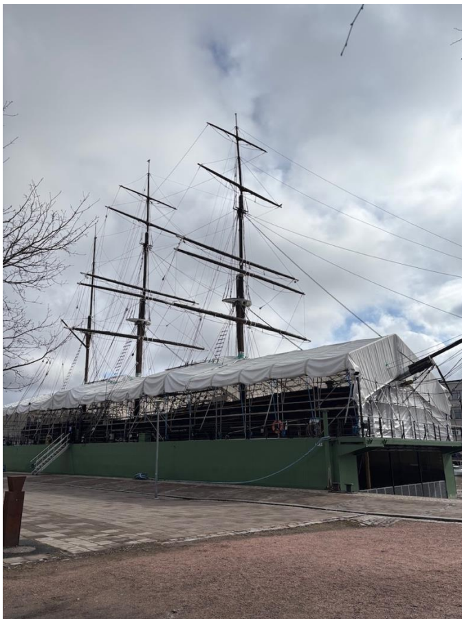
Kuva 11. Sigyn kuvattuna keulasta kohden Varvintorilla Aurajoenrannassa loken päällä. Sigyniä peittää sitä varta vasten rakennettu suojarakennelma, joka suojaa sitä esimerkiksi säältä. Kuva: Petra Viikkula
