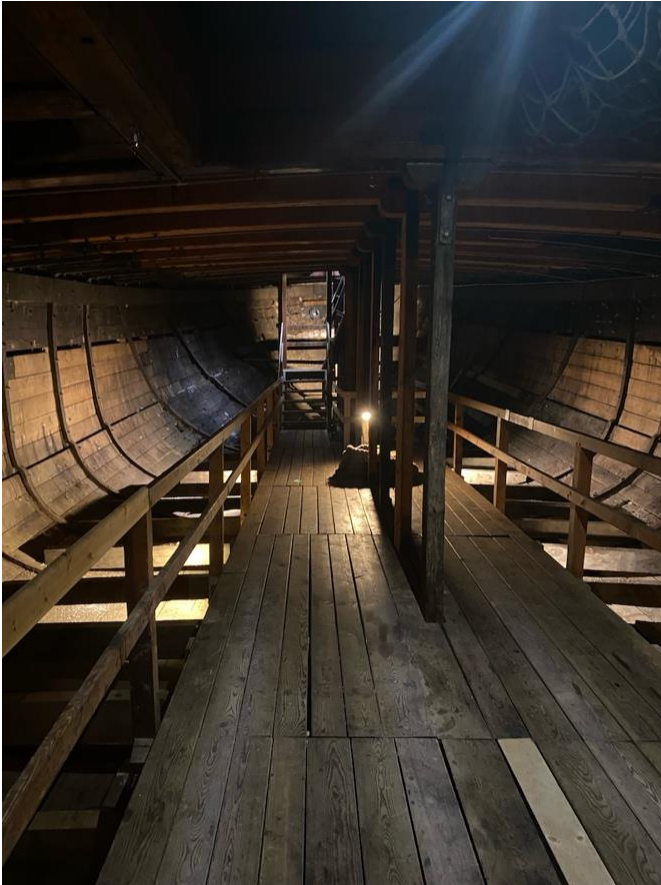
Kuva 4. Sigynin ruuma on täysin avoin vielä nykypäivänäkkin. Siitä ei ole varmuutta, onko ruumassa ollut millainen kulkuväylä miehistölle, mutta museolaivana ollessaan yleisö pääsee kulkemaan rakennettua lankkusiltaa pitkin ruuman läpi. Kuva: Petra Vilkkula
