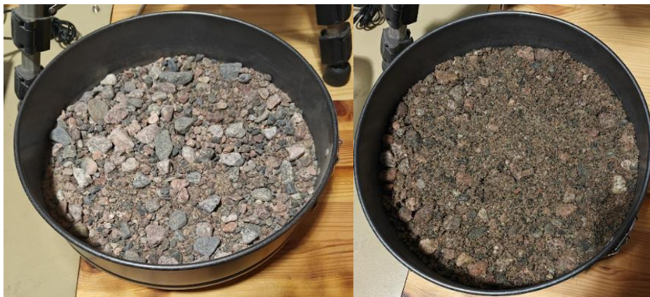
Kuva 21. Seos 1 kuivana sekä kastelun ja sekoituksen jälkeen, kun pienet partikkelit ovat sitoutuneet suurten partikkeleiden väleihin ja seos on tiivistynyt.
