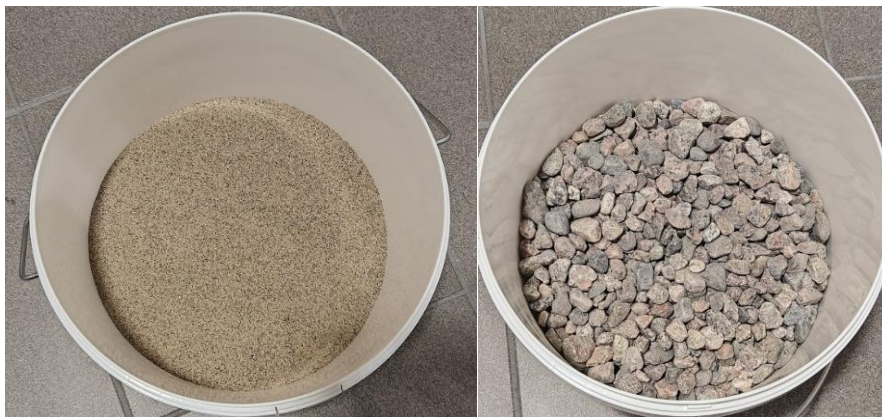
Kuva 17. Kokeessa käytetty halkaisijoiltaan 0,1–0,6 ja 8–16 mm:n kokoinen kiviaines.
