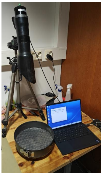
Kuva 18. Kokeissa käytetty mittalaitteisto. WCM411 kuvan yläreunassa mustan putken yläpäässä osoittaen pyöreää leivonta-astiaa, johon näytteet laitettiin.
