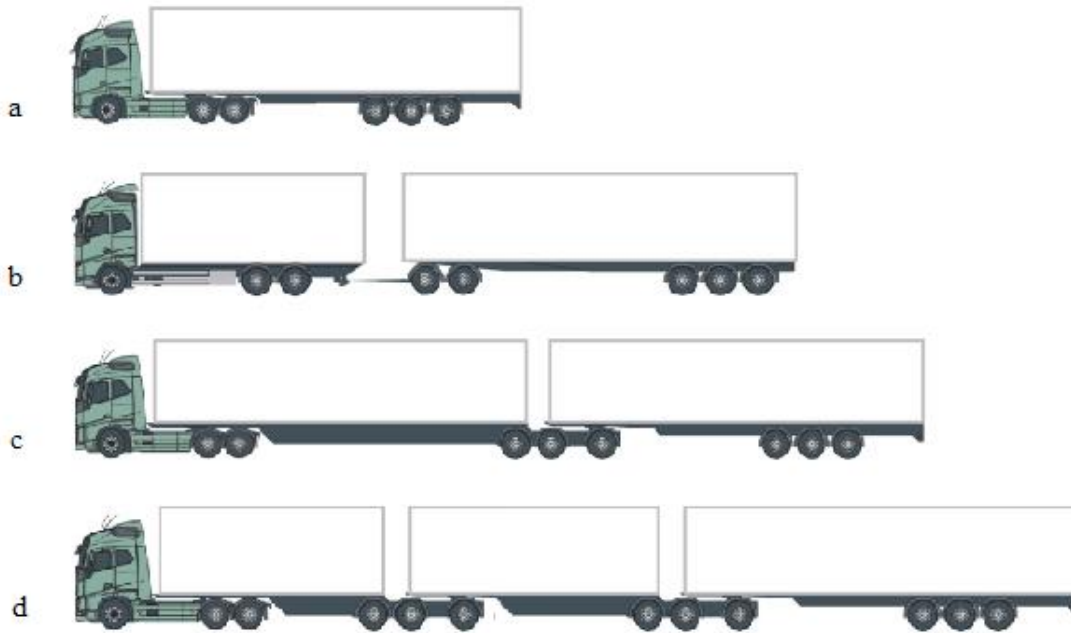
Kuva 8. Esimerkkejä Suomessa liikenteessä yleisesti käytettävistä ajoneuvoyhdistelmistä (kuormatilojen kokoineen): a) puoliperävaunuyhdistelmä (13,5 metriä), b) täysperävaunuyhdistelmä (7,5 + 13,5 metriä) c) HCT-yhdistelmä (13,5 + 13,5 metriä) ja d) HCT-yhdistelmä (7,5 + 7,5 + 13,5 metriä). Mukailten Murto (2018).
