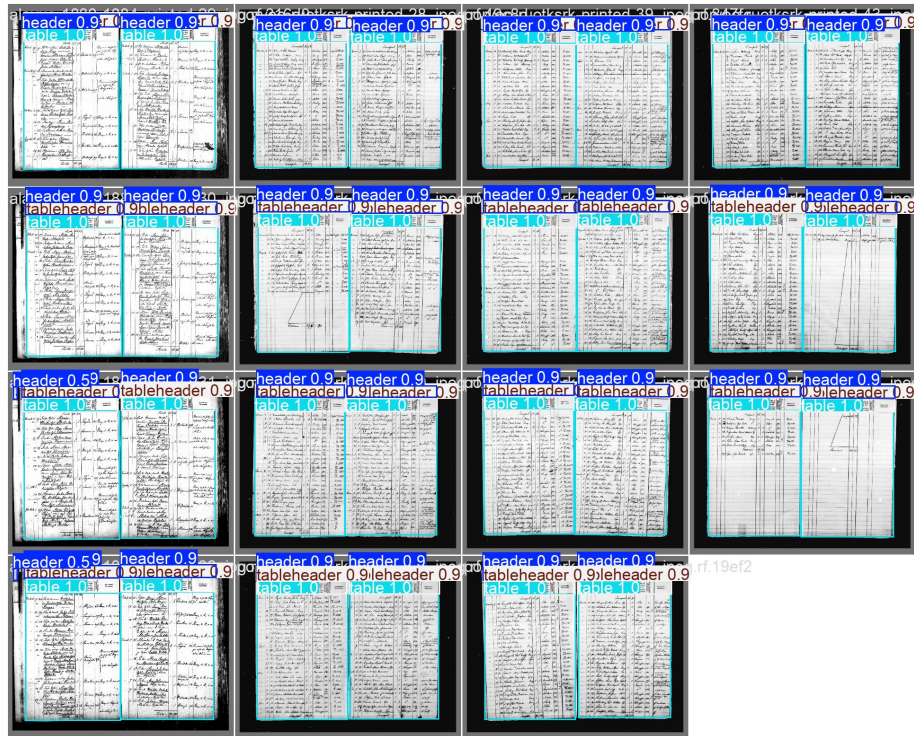
Kuva 4.1: YOLO11s mallin ennustamia lukemia printatulle testi-aineistolle. Parametrit: 100-epokkia, batch size 16, AdamW-optimointi.
