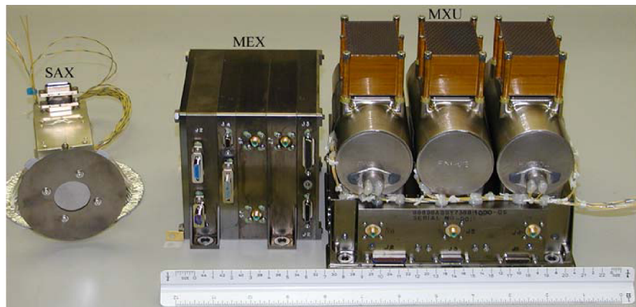
Kuva 2. Röntgenspektrometrin komponentit, oikealla Merkuriusta havainnoinut sensori MXU, vasemmalla Aurinkosensori SAX ja keskellä laitteiden elektroniikkaa sisältävä MEX. [8]
