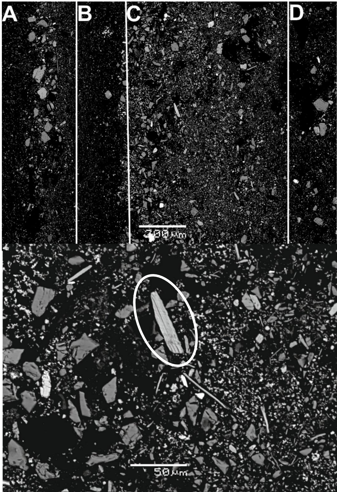
Kuva 55. Ylemmässä SEM-BSEI-kuvassa kohdissa B ja C vuoden 3 201 eaa. kevät- ja kesävalunnat Nautajärven lustosedimentin klastisessa laminaatiossa (Ojala 2001 ). Alemmassa kuvassa valkoisella ympyröity partikkeli, jota käytettiin virtausnopeuslaskuun.
