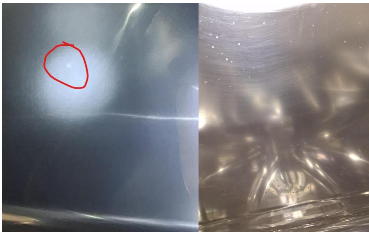
Kuva 22. Lääkemassajäämiä vesipesutesteistä. Oikeassa kuvassa pisteet kuvan alaosassa ovat vesipisaroita.
