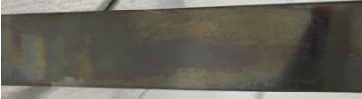
Kuva 14. "Rouging"-ilmiö ruostumattoman teräskomponentin pinnalla. [63]
