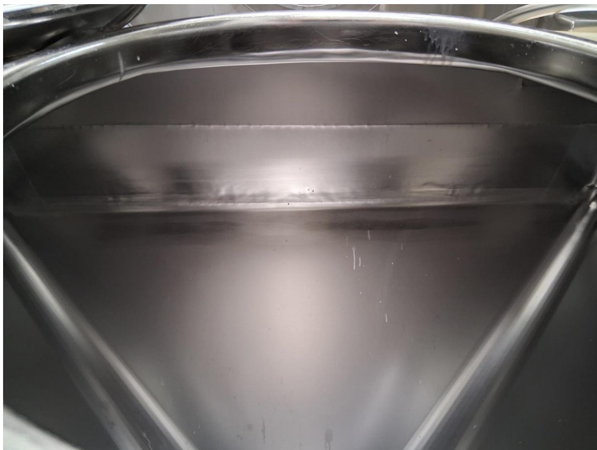
Kuva 5. Roiskeita ruostumattomalla teräspinnalla.
